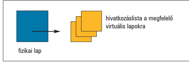
4. ábra A fordított térképezés egy fizikai lapot egy vagy több virtuális laphoz rendelhet
